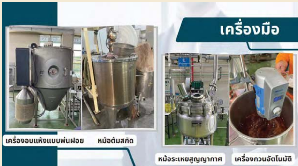
เครื่องมือสกัดและควบคุมคุณภาพผงสีธรรมชาติ Tools for the extraction and quality control of natural color pigments
